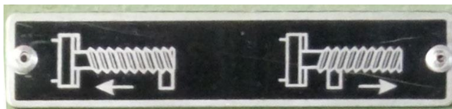
علامت حرکت سوپورت از طرف مرغک به طرف سه نظام راست تراش
