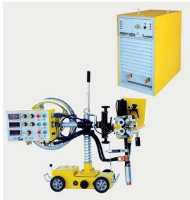
جوش زیر پودری یک فرایند جوش قوس الکتریکی است که در آن گرمای لازم برای جوشکاری توسط یک یا چند قوس بین یک فلز پوشش نشده، یک یا چند الکترود مصرفی و یک قطعه کار تامین می شود. قوس توسط لایه ای از فلاکس پودری قابل ذوب شدن که فلز جوش مذاب و فلز پایه نزدیک اتصال را پوشانده، و فلز جوش مذاب را از آلودگی های اتمسفر حفاظت می کند پوشیده می شود.
