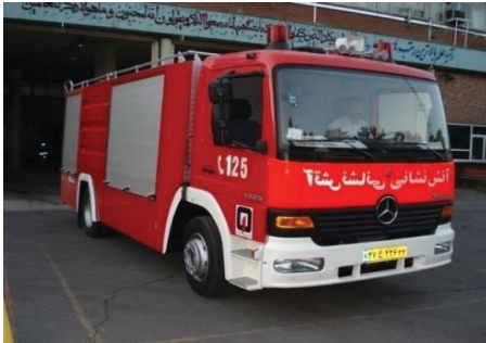
پسرو حریق (بنز آتگو تک کابین)
