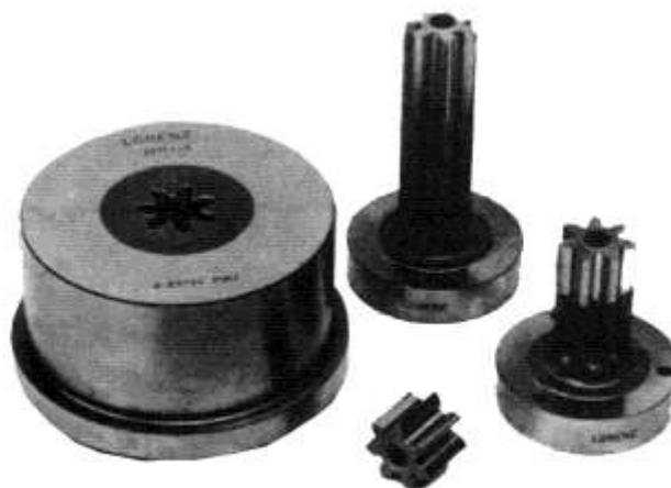
قالب متالورژی پودر و سنبه‌ی آن، همراه با چرخدنده‌ی تولید شده
