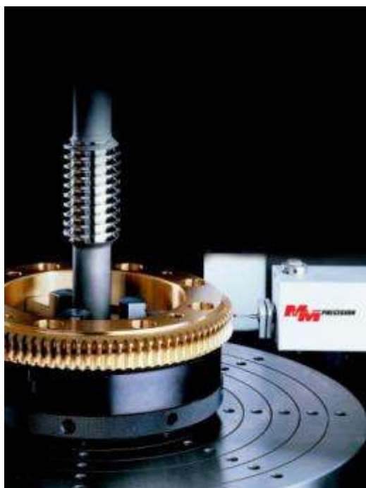
اندازه‌گیری چرخنده مخروطی مارپیچ (سمت راست) اندازه‌گیری چرخ و پیچ حلزون (سمت چپ)
