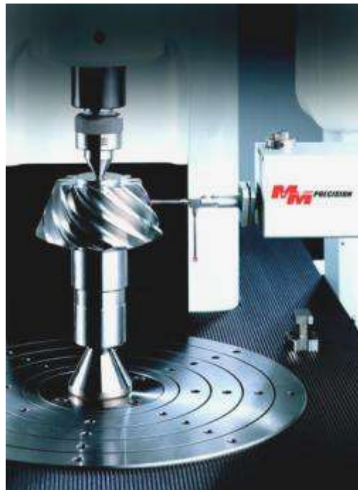
اندازه‌گیری چرخنده مخروطی مارپیچ (سمت راست) اندازه‌گیری چرخ و پیچ حلزون (سمت چپ)
